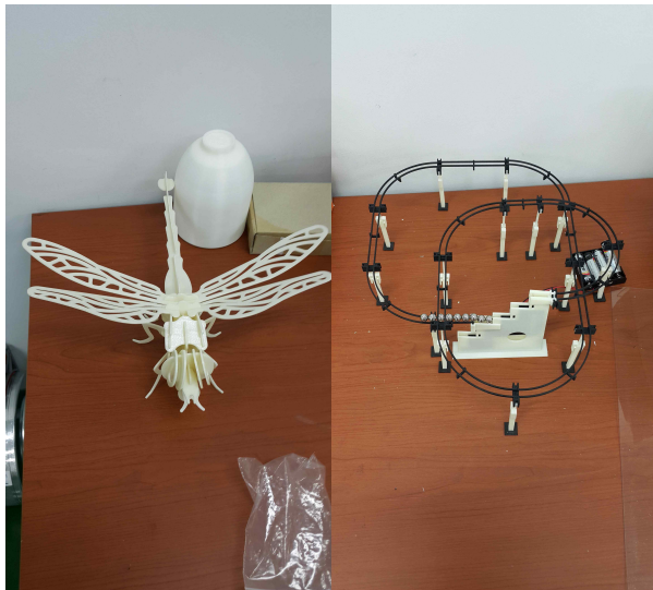
<그림 4-4> ABS-M30을 활용하여 3D 프린트로 제작한 모형
